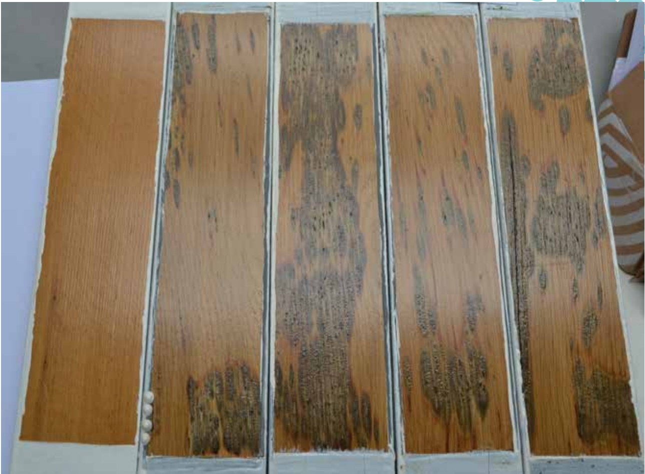
Fig. 1 Dégradations prématurées (après deux ans) constatées sur une finition de teinte claire appliquée sur des supports en chêne. L'éprouvette de gauche correspond à la référence non vieillie.
